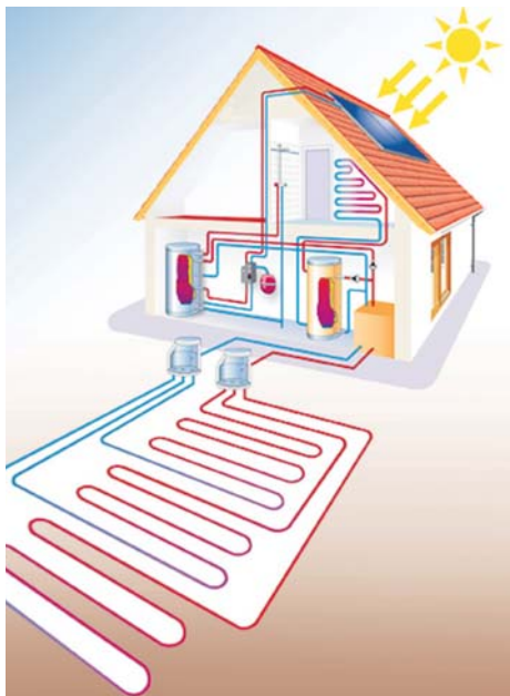
Eine Erdwärmepumpe entzieht dem Boden mit speziellen Spiralen Wärme und heizt damit ein ganzes Haus. Grafik: DBU
