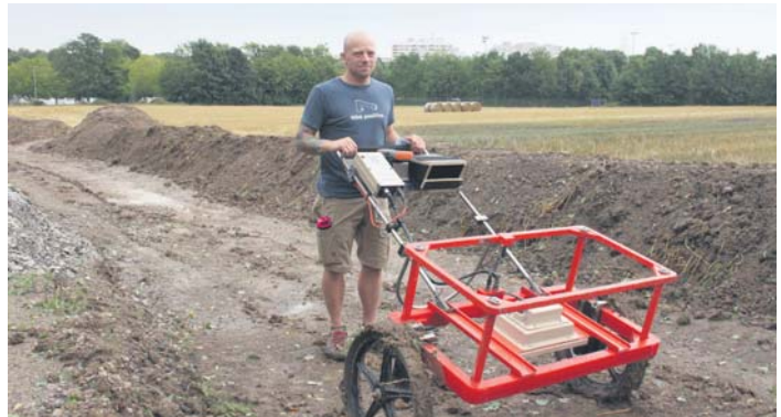
Mit einem speziellen Messwagen schickte Christian Albrecht elektromagnetische Wellen ins Erdreich und überprüfte so, ob Bomben aus dem zweiten Weltkrieg unter der Baustelle schlummern. Foto: Schlosser
