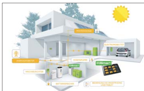
Moderne Wärmepumpen können mit Photovoltaik- und PV-Termie-Anlagen kombiniert werden – eine Lösung für Reihenhäuser, bei denen im Garten kaum Platz für die Anlage zur Verfügung steht. Grafik: M-Tec
